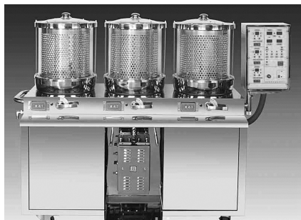
图 2-69 三桶自动煎药包装机
