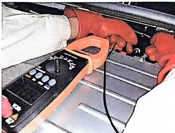
图 5-25 用绝缘万用表测量电压 (确认电压值为零)
