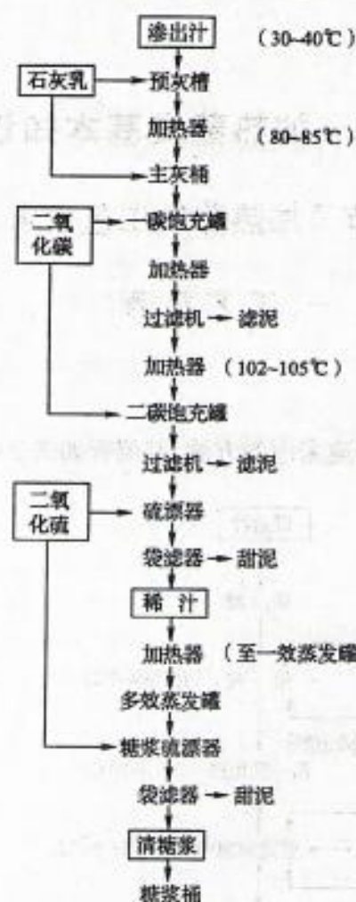
图 2-2 碳酸法工艺流程图
